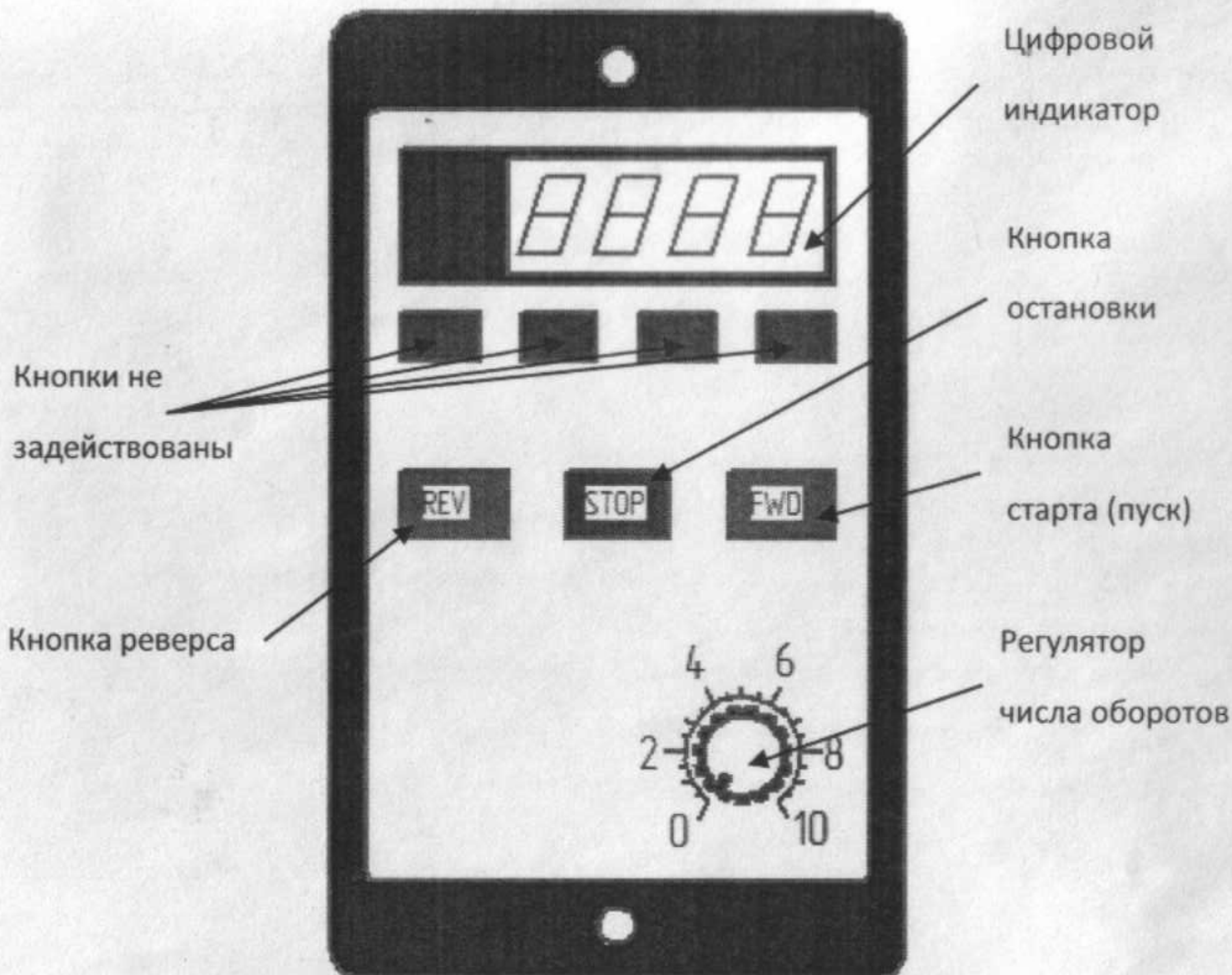
Рисунок 1 Элементы управления контроллера скорости
